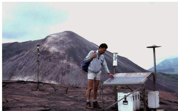
Une station de surveillance volcanique au pied du Yasur, au Vanuatu. De gauche à droite : un pluviomètre, un sismographe et une sonde thermique. Un panneau solaire permet d'alimenter les batteries.
