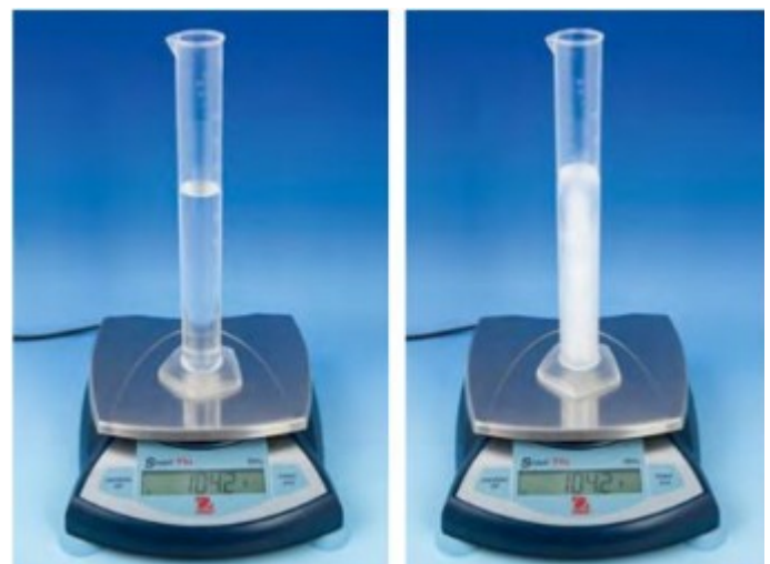
Document 2 : Étude de la masse et du volume lors de la solidification de l'eau
